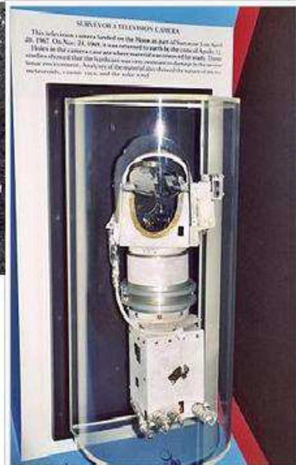
La caméra de Surveyor 3 rapportée de la lune par la mission Apollo 12, exposée au National Air and Space Museum.
