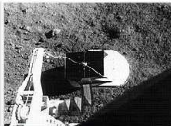
L'analyseur à particules alpha de Surveyor 3 est abaissé sur le sol lunaire.
